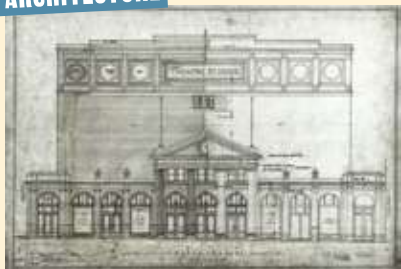
Plan de la façade du Théâtre St-Denis dessiné par le bureau d'architectes Barott, Blackader & Webster à Montréal en 1915. Image : Archives du Théâtre St-Denis.
